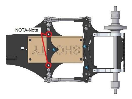
Nota: con la batteria in linea, le colonne FX1148, possono essere montate nei fori più stretti
