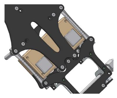
Se usate le Shorty "Slim" e dovete rientrare nel peso limite, potete mettere zavorra sotto le pile stesse, abbassando ulteriormente il CG. Inoltre, un buon posto, può essere sotto l'asse posteriore.
