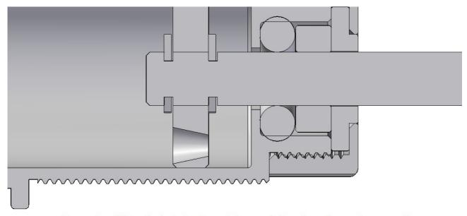
Quando utilizzate i pistoni conici, prestate attenzione al verso di utilizzo. Nell'esempio l'ammortizzatore sarà più morbido in estensione e duro in compressione
