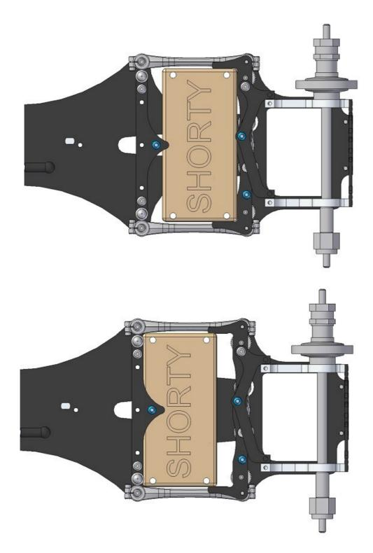
La batteria, in posizione traversa, può essere posizionata completamente indietro, oppure 10mm verso l'anteriore
